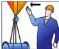
Trascinamento laterale del gancio a carico.
