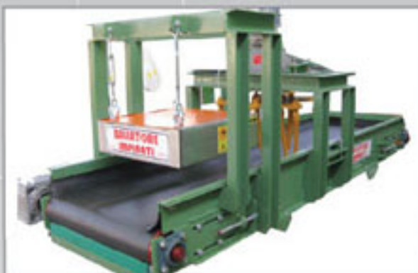
TAPPETO IN GOMMA, MAGNETE, RIPARTITORE RUBBER BELT, MAGNET, LEVELING DEVICE TAPIS CAOUTCHOUC, AIMANT, RÉPARTITEUR
